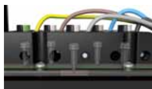
Sichere Kontaktierung mittels Durchdringungs-Kontakten.
